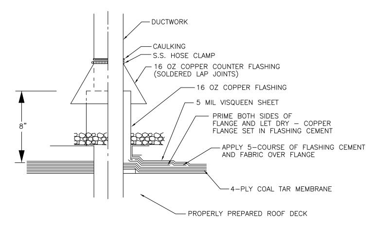
NOTE: ALL JOINTS SHALL BE SOLDERED.
