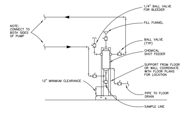
CHEMICAL SHOT FEEDER PIPING DIAGRAM
